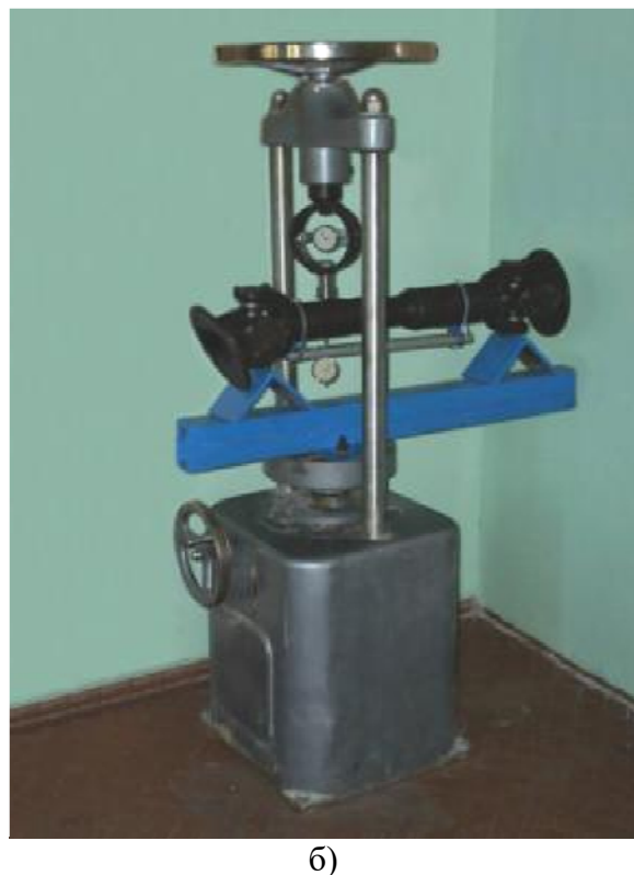
Рис. 1. Стенд для определения изгибной жесткости шлицевого соединения вала карданной передачи: а – схема; б – общий вид
