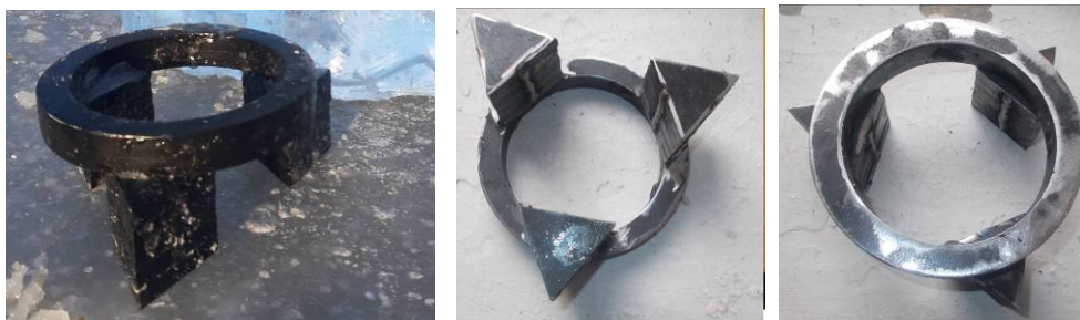
Рис. 2. Штамп, имитирующий внедрение винтовой лопасти в лёд
