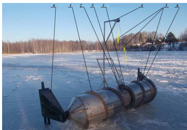
Рис. 1. Установка для испытания образца роторного движителя на уровень генерируемого шума:
